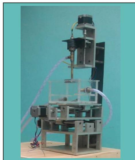
Gambar 2. Konstruksi sistem mekanikal Mesin ECM.
