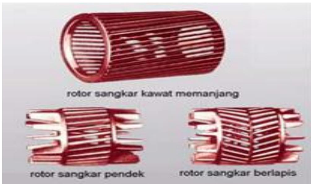
Gambar 2.8 Bentuk rotor sangkar
