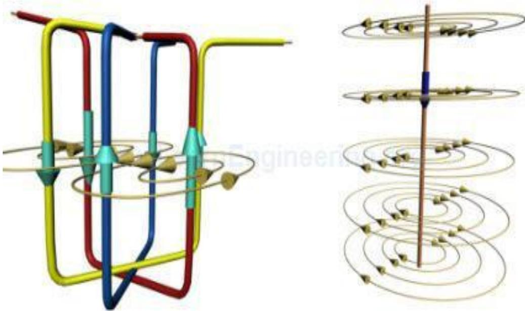
Gambar 2.10 Arus pada kabel menghasilkan fluks
