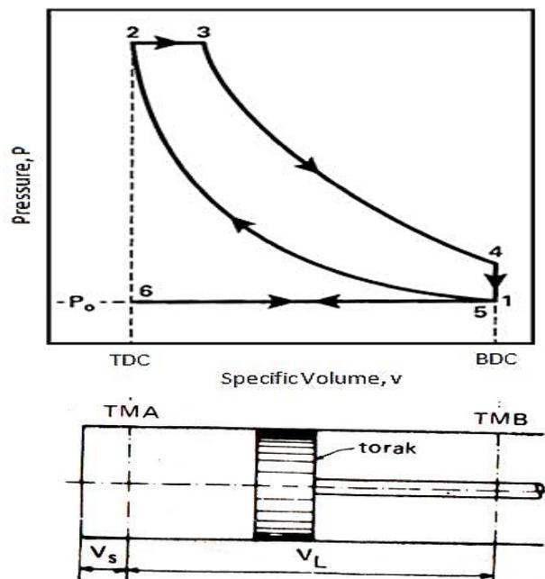
Gambar 2.5 Diagram P dan V dari siklus volume konstan
