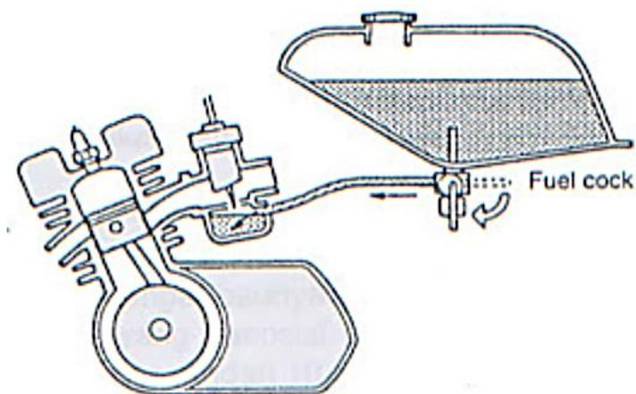
Gambar 2.10 Komponen sistem bahan bakar pada motor bensin.
