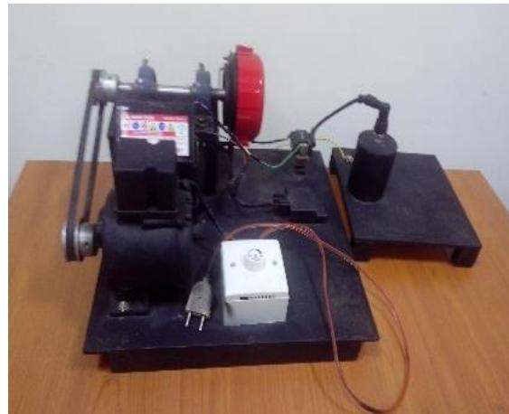
**Gambar 3.17.** Alat penguji percikan bunga api pada busi
