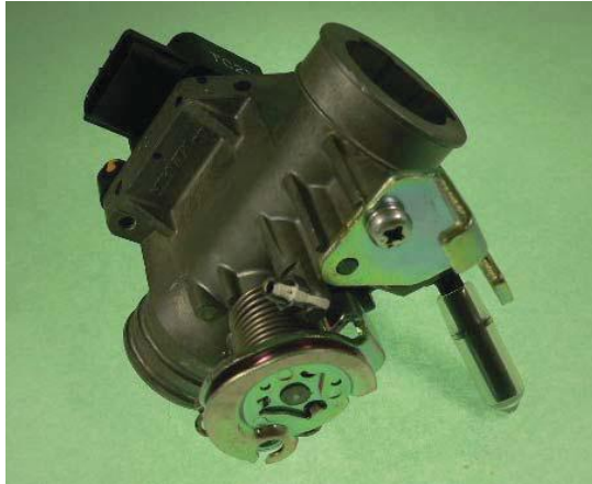
Gambar 2.15. Konstruksi Throttle Body (Unit Pelaksana Teknis Pelatihan Kerja Mojokerto, 2009)
