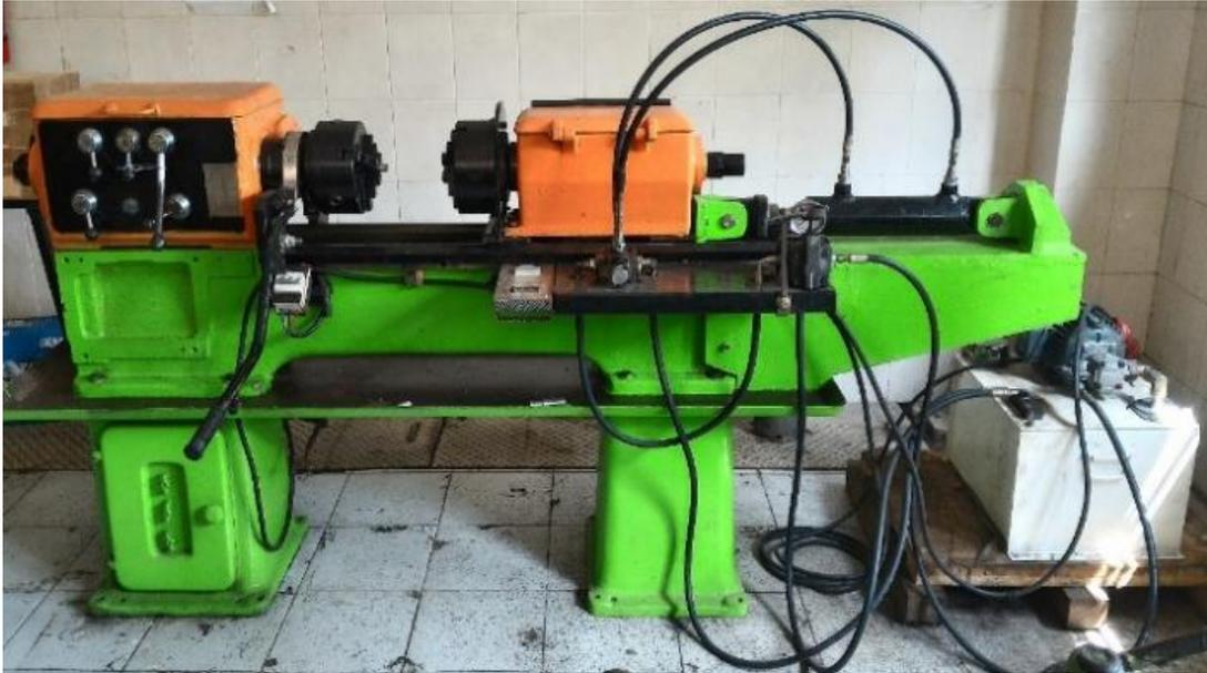
**Gambar 3.3.** Mesin las gesek yang digunakan sebagai las gesek Alumunium Alloy 2024-T4 dan Stainless Steel AISI 420
