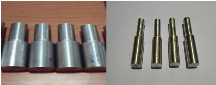
**Gambar 3.11.** Hasil pemotongan bahan aluminium dan stainless yang sudah dibuat standar *JIS* Z 2201
