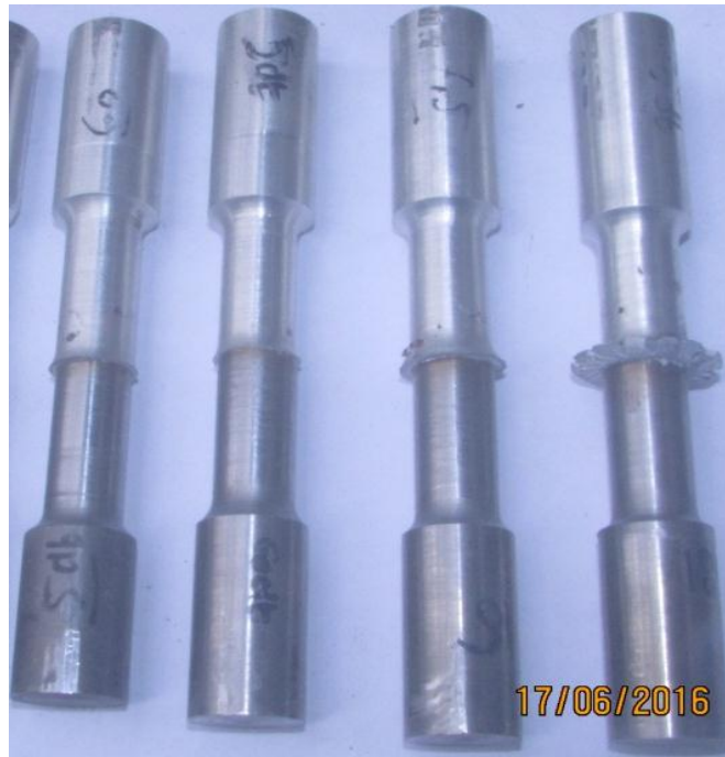
Gambar 4.2. Hasil pengelasan gesek AA2024-T4 dan SS AISI 420
