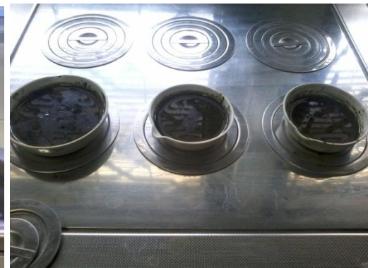
Evaporasi dengan waterbath
