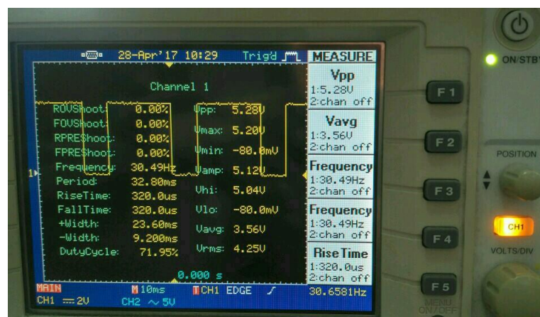
Gambar 4.6. Nilai Duty Cycle pada Osiloskop Suhu Sedang
