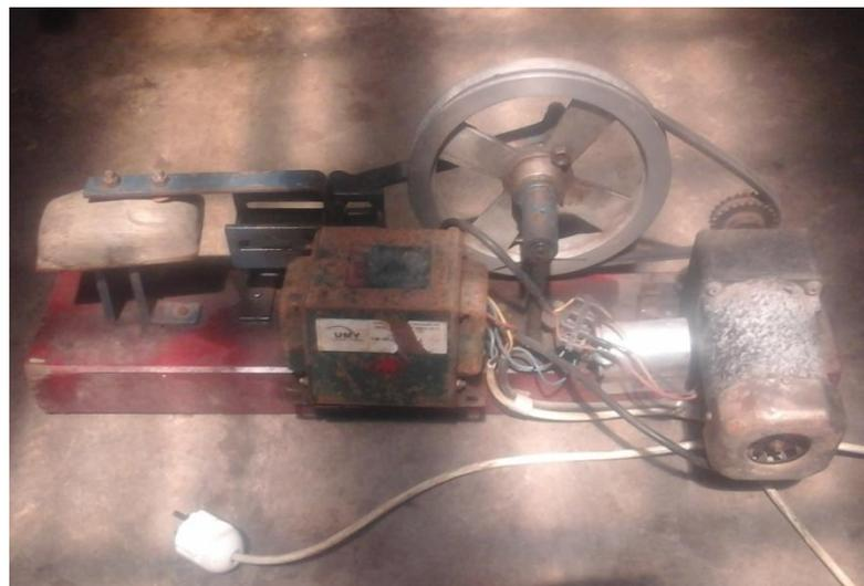
Gambar 3.11 Alat Uji Keausan
