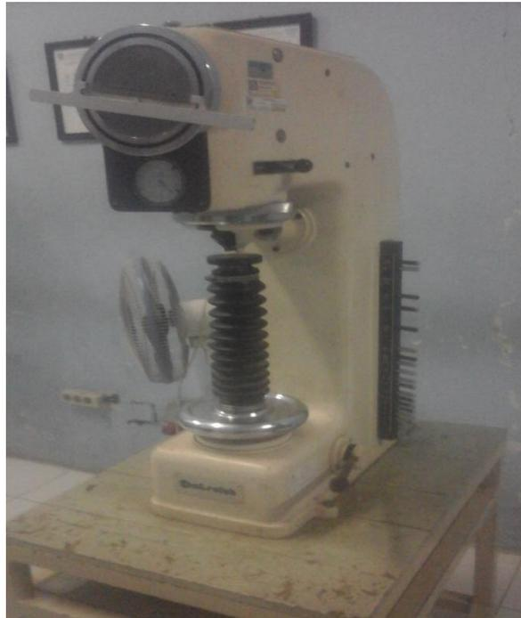
Gambar 3.10 Mesin Uji Kekerasan
