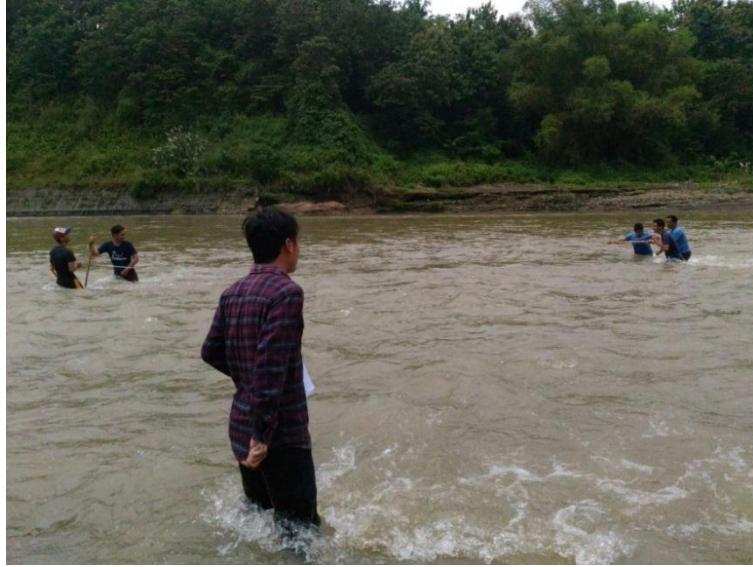
Gambar 4.19 Pengambilan data kecepatan aliran
