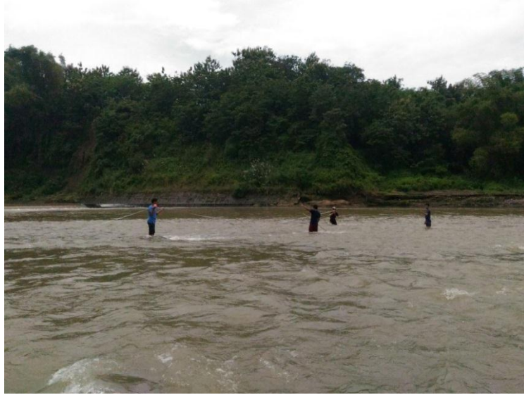
Gambar 4.21 Pengukuran lebar aliran sungai
