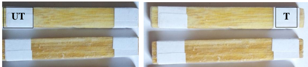
Gambar 4.8 Spesimen uji bending (R) : Raw; (UT) : Untreatment ; (T) : Treatment
