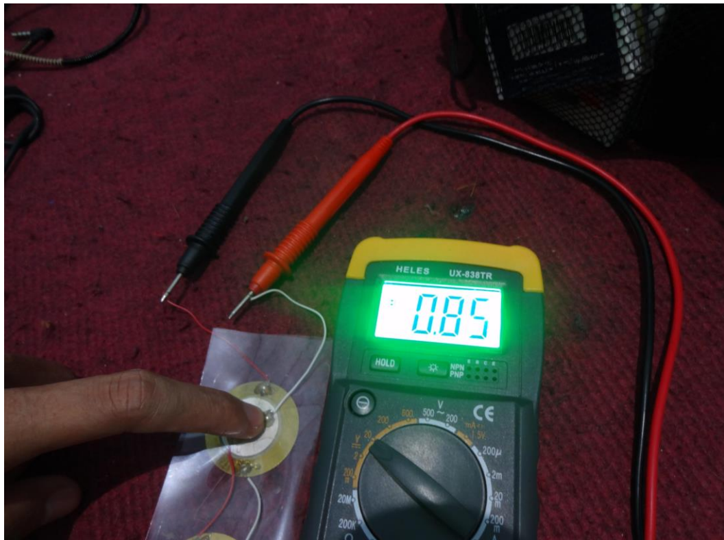
Gambar 4.5 Pegukuran tegangan pada piezoelectric
