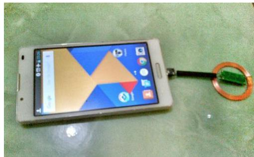
Gambar 3.5 Desain perangkat bagian penerima kompatibel dengan telepon genggam
