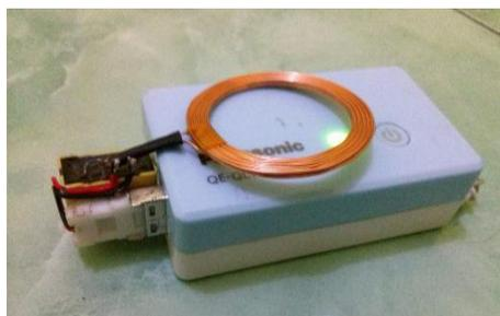
Gambar 3.4 Desain perangkat bagian pemancar kompatibel dengan *power bank*
