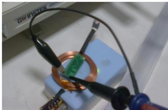
Gambar 3.13 Contoh pengambilan data pengujian penghalang jarak tetap berbahan kaca.
