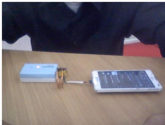
Gambar 3.16 Contoh pengambilan data kecepatan pengisian daya menggunakan kabel.
