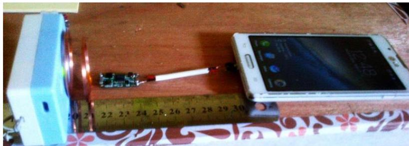
Gambar 3.11 Contoh pengambilan data pengujian jarak terhadap arus.
