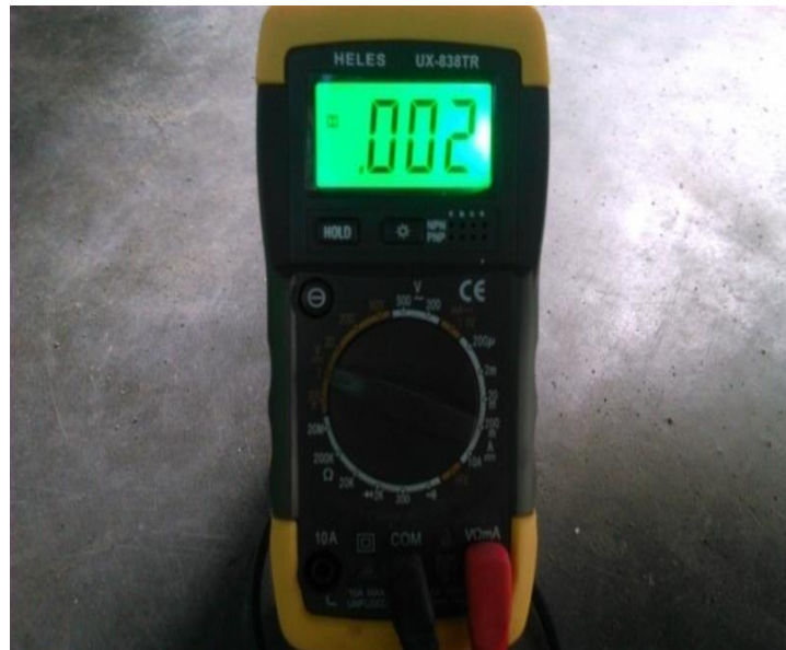
Gambar 4.8 Tegangan pulser saat Rpm 1500
