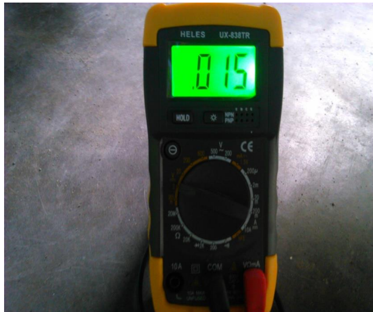
Gambar 4.10 Tegangan pulser saat Rpm 10.000
