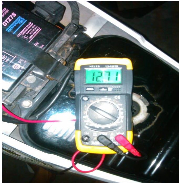
Gambar 4.3 Pengujian tegangan catu daya accu
