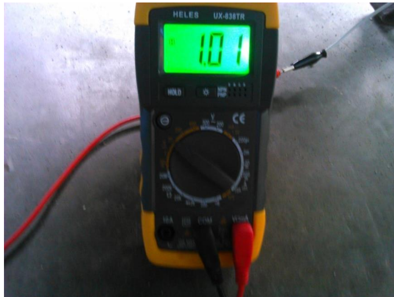
Gambar 4.11 Tegangan Op-amp saat Rpm 1500
