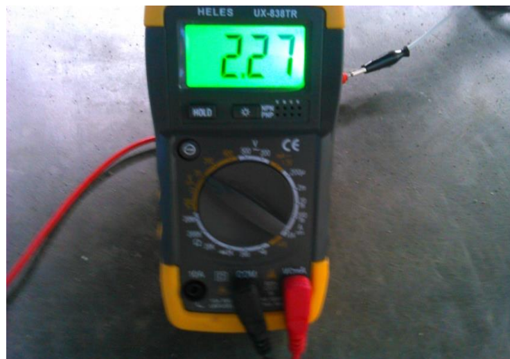
Gambar 4.12 Tegangan Op-amp saat Rpm 5000
