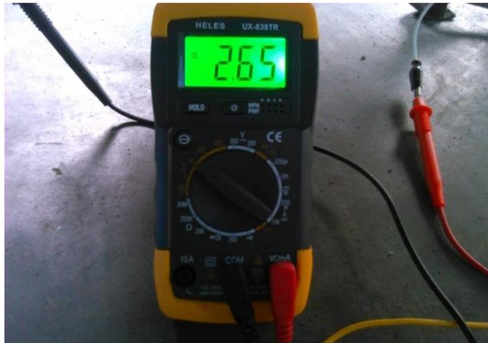
**Gambar 4.13** Tegangan Op-amp saat Rpm 10.000
