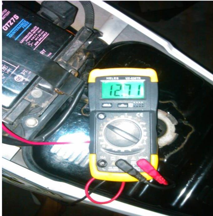
**Gambar 4.3** Pengujian tegangan catu daya accu
