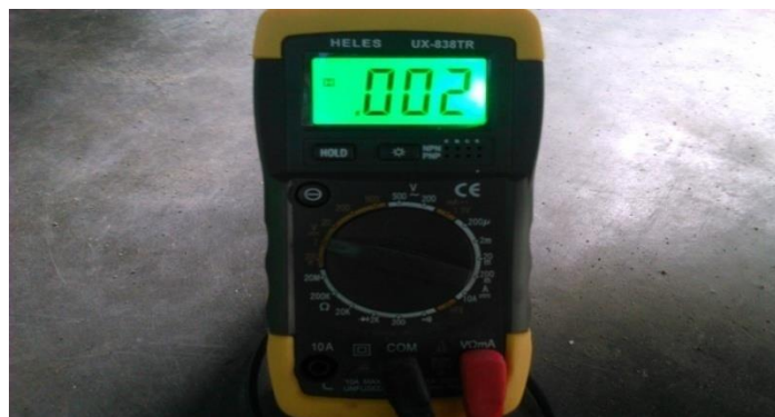
Gambar 4.8 Tegangan pulser saat Rpm 1500
