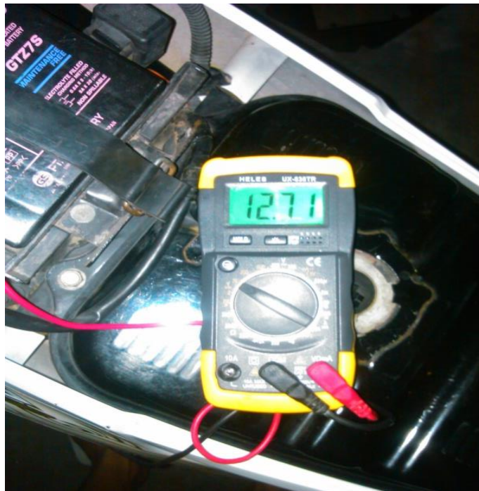
Gambar 4.3 Pengujian tegangan catu daya accu
