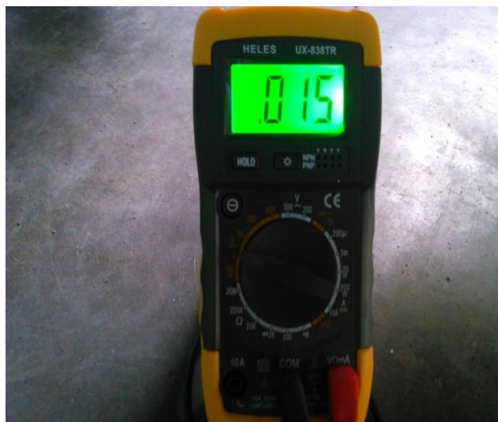
Gambar 4.10 Tegangan pulser saat Rpm 10.000
