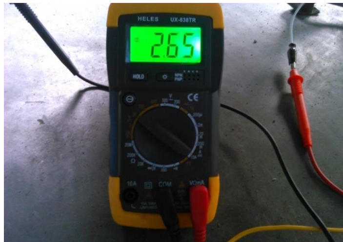
Gambar 4.13 Tegangan Op-amp saat Rpm 10.000
