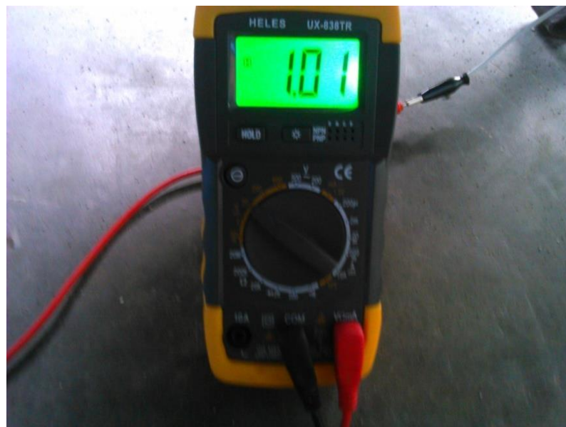
Gambar 4.11 Tegangan Op-amp saat Rpm 1500
