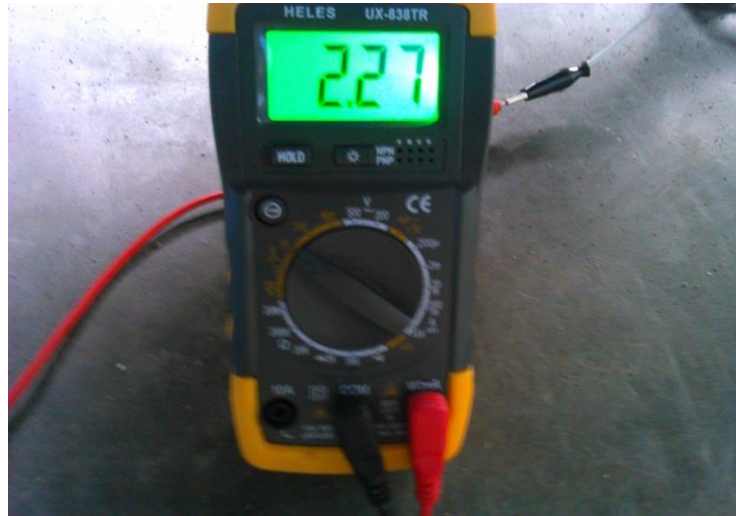
Gambar 4.12 Tegangan Op-amp saat Rpm 5000
