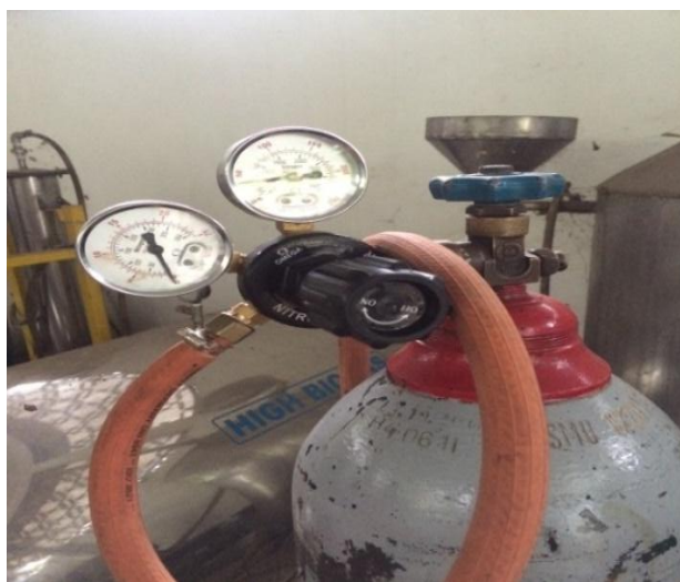
Gambar 3.4 Tabung Nitrogen, Selang dan Regulator.
