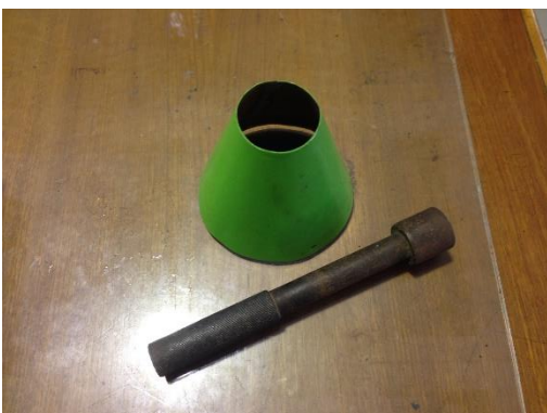
Gambar 21. Alat uji SSD (kerucut dan penumbuk)
