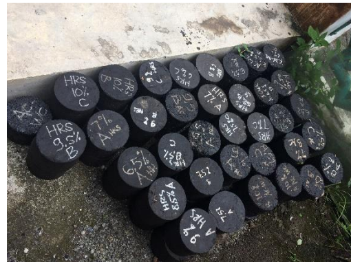
Gambar 26. Benda uji setelah uji Marshall
