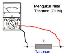
Gambar 3.41 posisi saat mengukur tahanan (Fahrudin, 2013)
