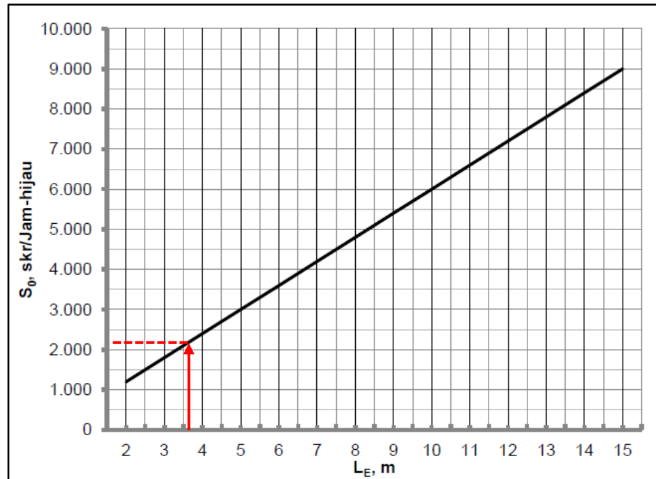
Gambar 3.2 Diagram arus jenuh dasar tipe pendekat terlindung, P
