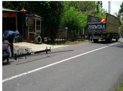
g. Pembacaan Arlogi Ukur Alat Benkleman Beam
