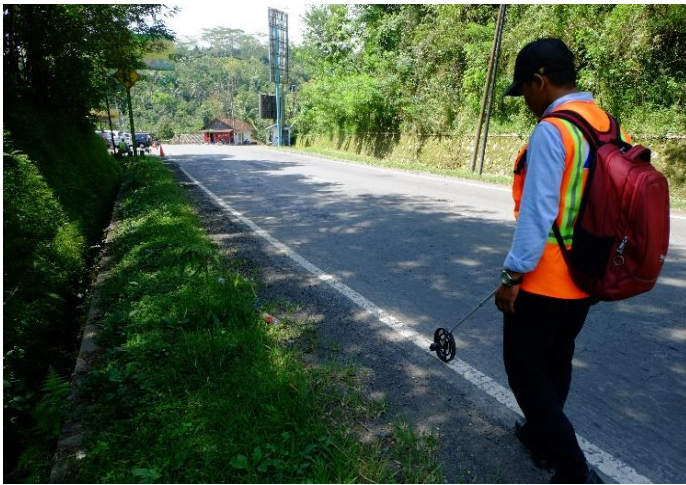
Gambar 4 Proses Pengukuran Jalan
