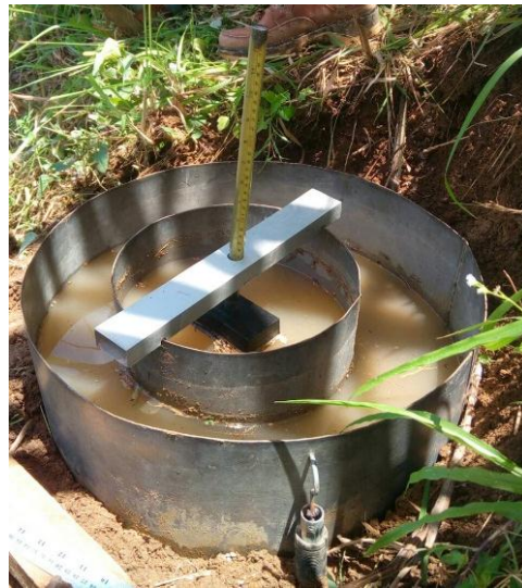
Gambar 3.8 Pengukuran laju infiltrasi
