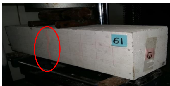
Gambar 5.6 Keretakan balok hasil pengujian tahap I
