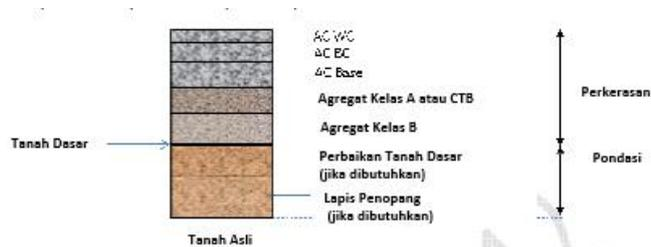
Gambar 2.1 Struktur perkerasan lentur pada permukaan tanah asli (Bina Marga 2013)
