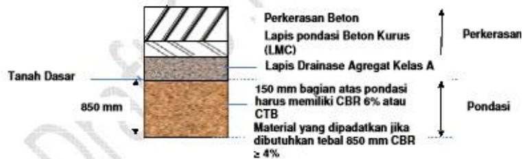
Gambar 2.6 Struktur perkerasan kaku pada galian (Bina Marga 2013)
