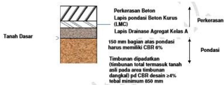
Gambar 2.5 Struktur perkerasan kaku pada timbunan (Bina Marga 2013)
