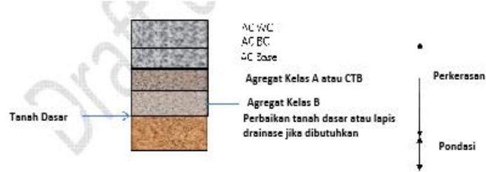
Gambar 2.3 Struktur perkerasan lentur pada galian (Bina Marga 2013)
