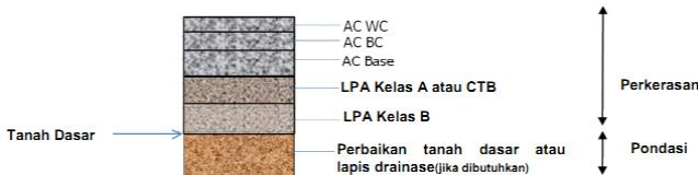
Gambar 3. Struktur perkerasan lentur pada galian (Bina Marga 2013)
