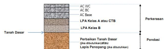
Gambar 1. Struktur perkerasan lentur pada permukaan tanah asli (Bina Marga 2013)
