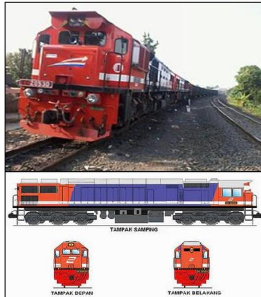
**Gambar 5. 9** Lokomotif CC205 dengan sistem pengereman udara tekan
