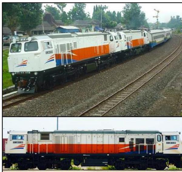
**Gambar 5. 8** Lokomotif CC206 dengan sistem pengereman udara tekan
