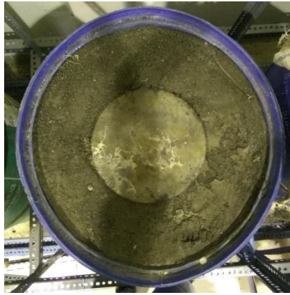
Gambar 1. 1 Tanah lempung ekspansif yang telah di perkuat dengan kolom SiCC
