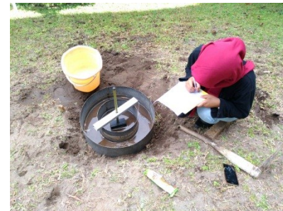
Gambar 11 Pengujian Kapasitas Infiltrasi
