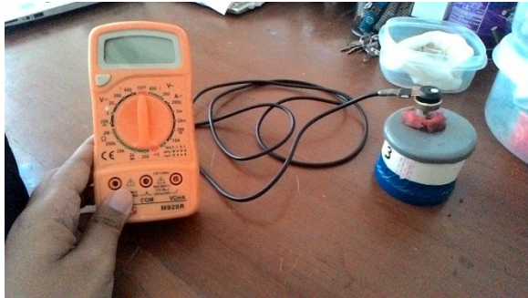
Gambar 10 Pengujian SWRC menggunakan alat KU-Tensiometer
