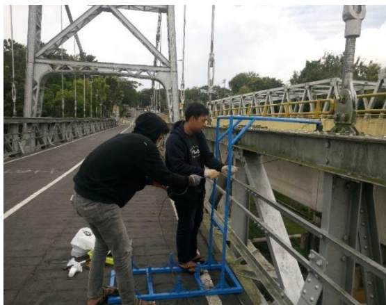
Gambar 4.14 Penurunan Alat Helley Smith
