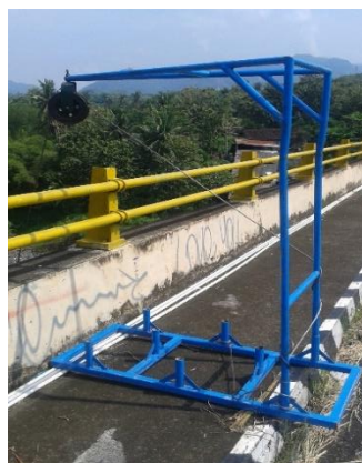
Gambar 4.11 Alat Aangkutan Sedimen Dasar Helley Smithi
