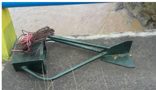
Gambar 4.11 Alat Aangkutan Sedimen Dasar Helley Smithi
