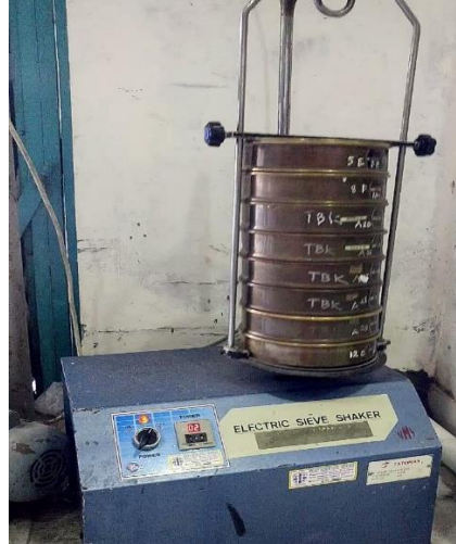
Gambar 4.18 Set Ayakan dan Alat Penggetar
