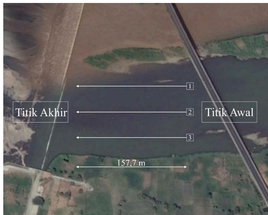
Gambar 5.5 Pengambilan data kecepatan air
