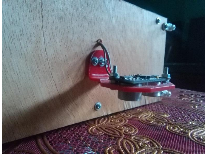
Gambar 3.17 Penempatan sensor PING)) Parallax (tampak samping)
