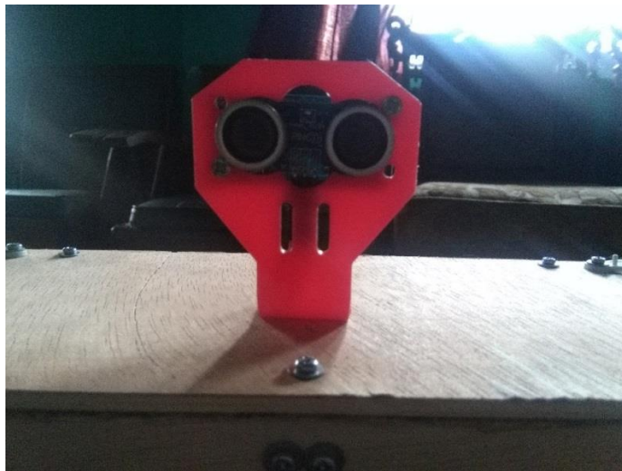
Gambar 3.18 Penempatan sensor PING)) PARalax (tampak depan)
