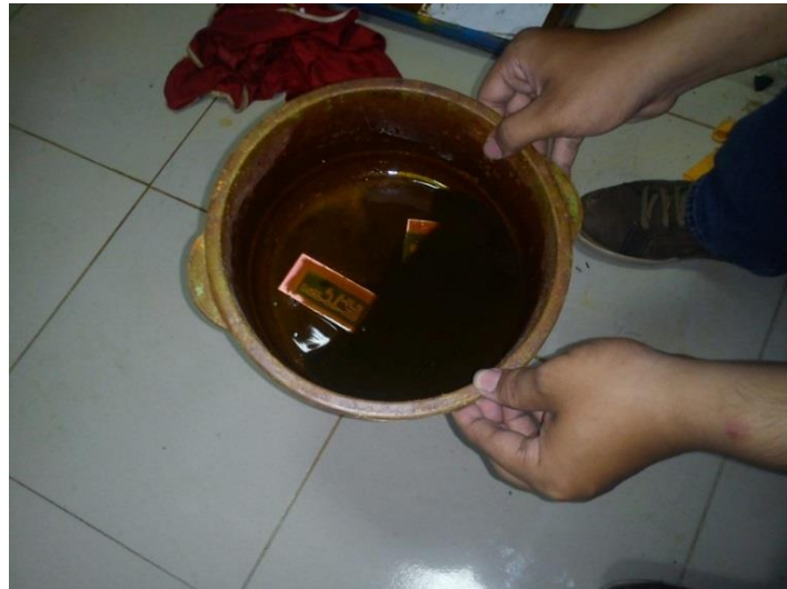
Gambar 3.21 Proses Pelarutan dengan \text{FeCl}_3
