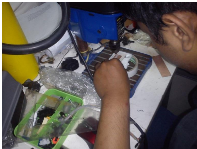
Gambar 3.22 Melakukan Pengeboran Lubang – Lubang Komponen
