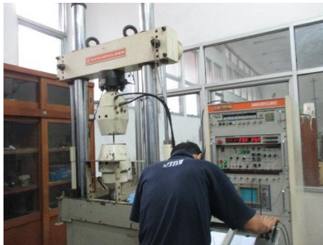
Gambar 3.29. Proses persiapan mesin uji tarik
