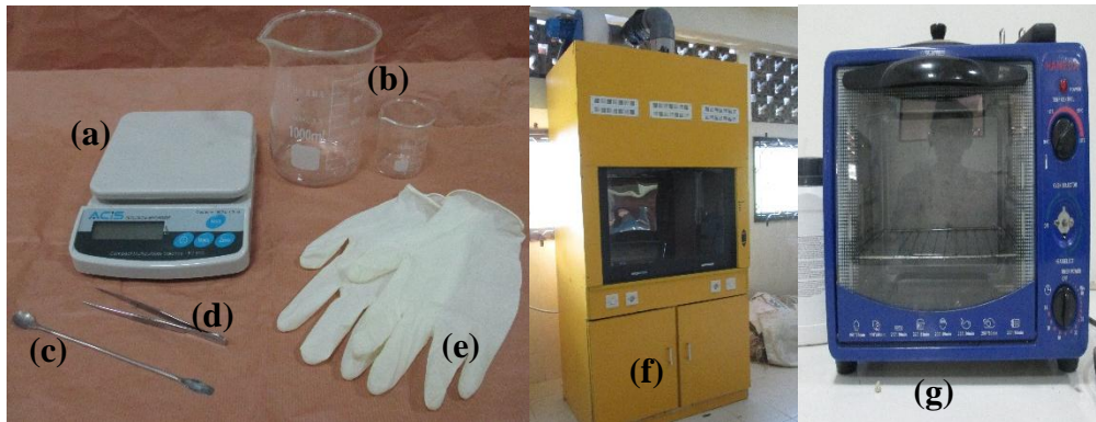
Gambar 3.1. Peratalatan proses alkalisasi (a). timbangan digital (b). gelas ukur dan gelas beker (c). sendok pengaduk (d). pin set (e). sarung tangan karet (f). lemari asam (g). oven.
