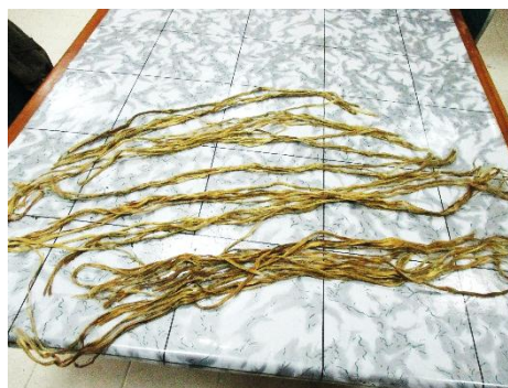
Gambar 3.18. Proses pengeringan serat kenaf
