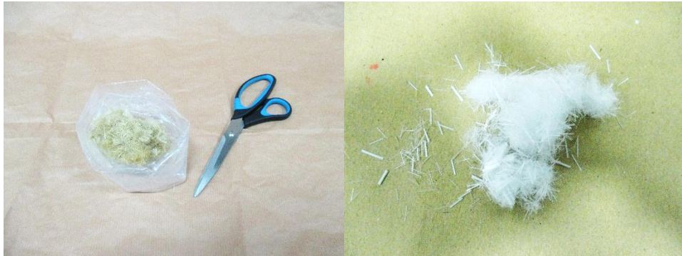
Gambar 3.19. Serat kenaf dan serat E-Glass yang sudah dipotong sesuai ukuran
