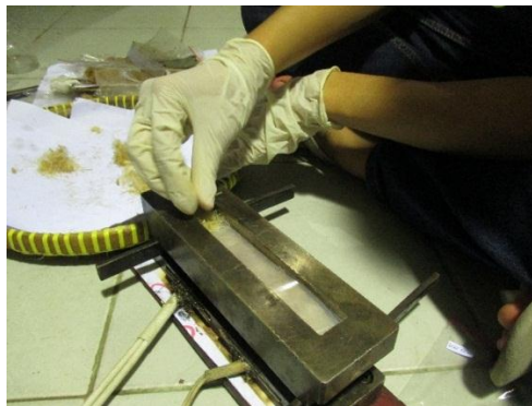
Gambar 3.23. Penyusunan serat dan matriks secara laminat.
