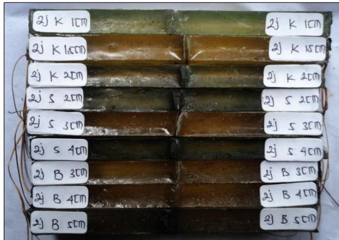
**Gambar 3.24.** Spesimen yang sudah diberi label
