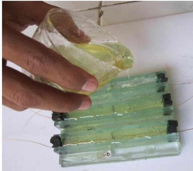
**Gambar 3.21.** Penuangan resin
