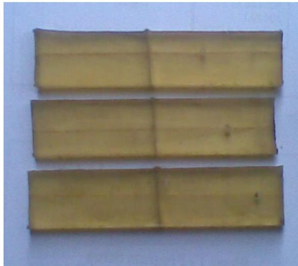
**Gambar 3.23.** Contoh spesimen yang sudah dibor
