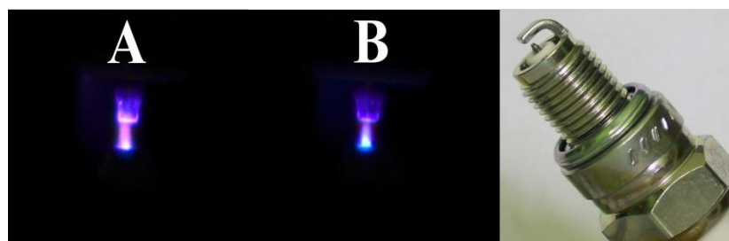
Gambar 4.4. Percikan bunga api busi NGK CR7HGP ( G-Power ) dengan magnet bubutan (A) dan magnet standar (B)
