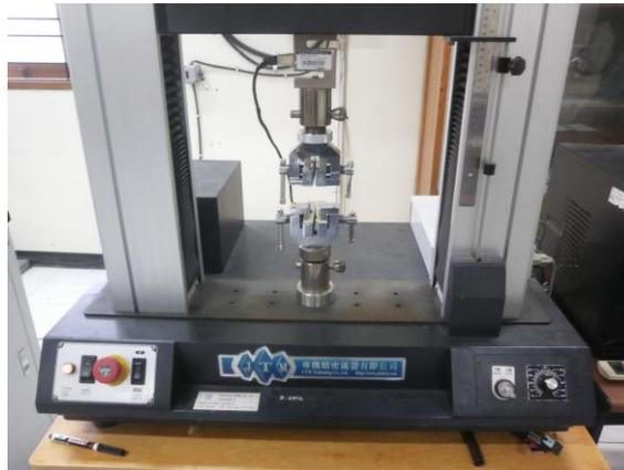
Gambar 3.8 Mesin Uji Tarik UTM
