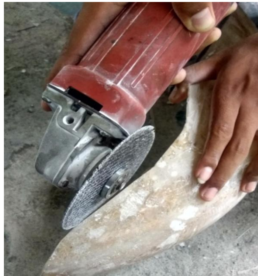
Gambar 4.12 Pemo tongan dengan gerinda
