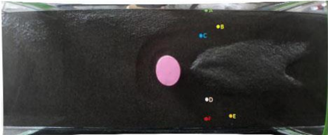
Gambar 5.16 Pola pergerakan aliran di sekitar pilar lingkaran tiap 0,14 detik (a – f)
