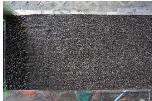
Peredam Energi di Hulu saluran
