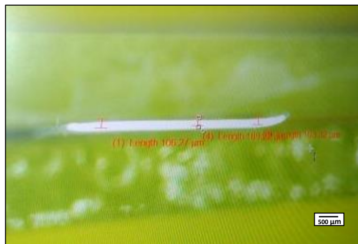
Gambar 3.26. Pengukuran ketebalan : a) Pemasangan sampel, b) Hasil pengukuran ketebalan menggunakan optical microscope
