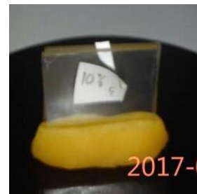
Pengukuran ketebalan spesimen menggunakan OM
