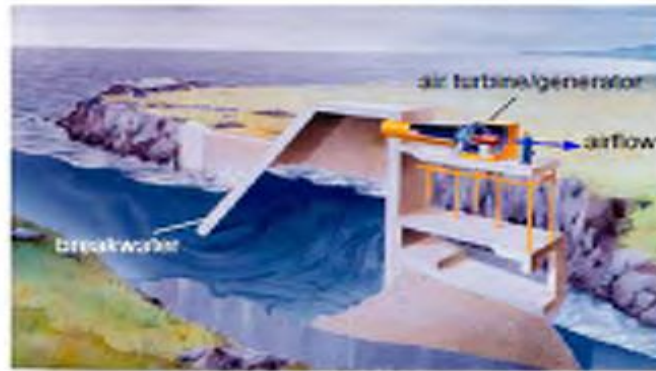
Gambar 2.4 Energi gelombang (kinetik dan potensial) sebagai penggerak turbin.
