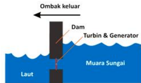
Gambar 2.7.8.1 Skema air laut yang keluar menggerakkan turbin
