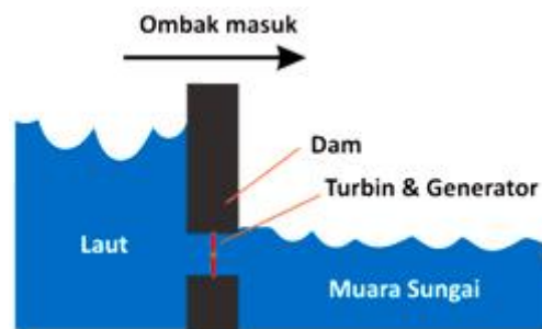
Gambar 2.7.8 Skema pembangkitan saat ombak masuk
