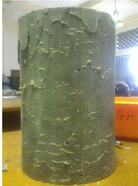
Gambar 5.4 Sampel benda uji setelah diuji tekan
