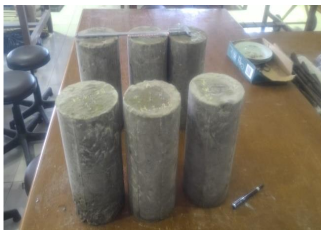
Gambar 5.2 Sampel uji tekan beton umur 28 hari sebelum diuji tekan
