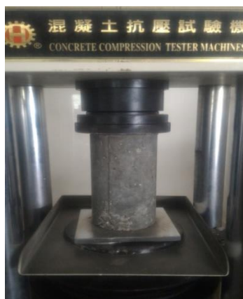
Gambar 5.3 Pengujian uji tekan beton
