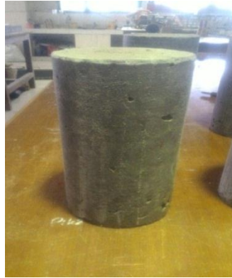
Gambar 5.2 Beton umur 28 hari
