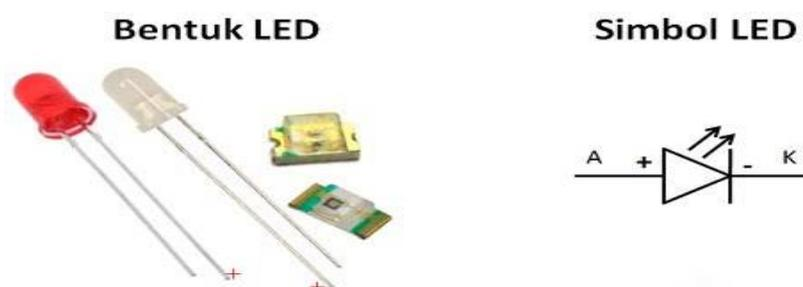
Gambar 2.10 Bentuk dan simbol dari LED (*Light Emitting Diode*)
