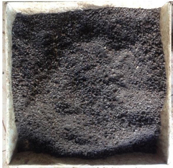
Gambar 3. 12 Pencampuran tanah dengan air
