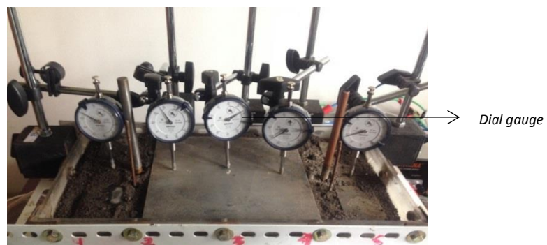
Gambar 3. 15 Pemasangan dial gauge
