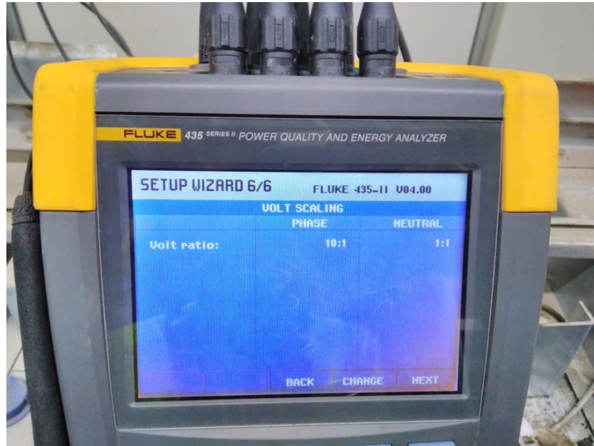
Gambar 4.8 Menentukan skala tegangan yang digunakan motor induksi 3-fasa.
