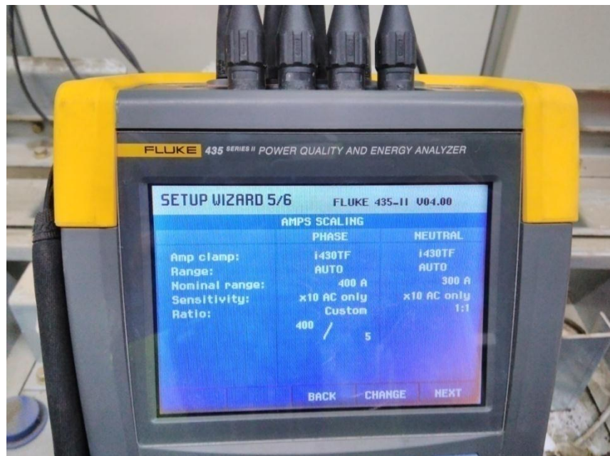
Gambar 4.7 Menentukan skala arus yang digunakan pada motor induksi 3-fasa.
