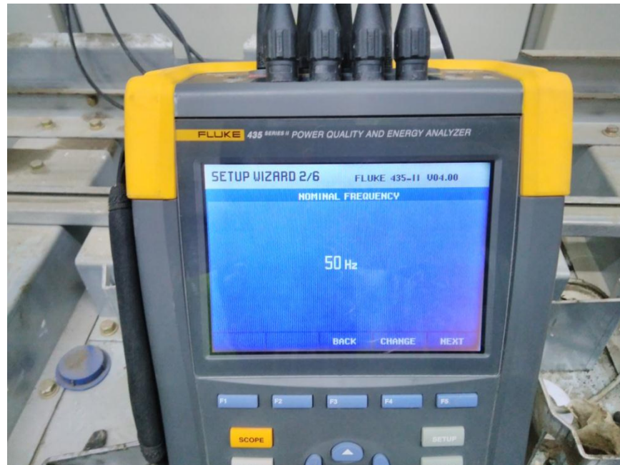
Gambar 4.4 Menentukan frekuensi yang digunakan pada motor induksi 3-fasa.
