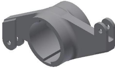
Gambar 4.23 Desain *arm torque R*
