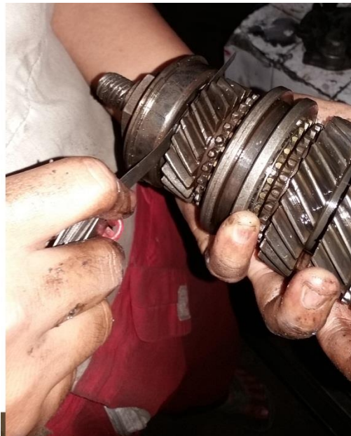
Gambar 4. 10 Pengukuran Ukur kelonggaran antara thrust washer gigi ke 4 dan gigi ke 4.
