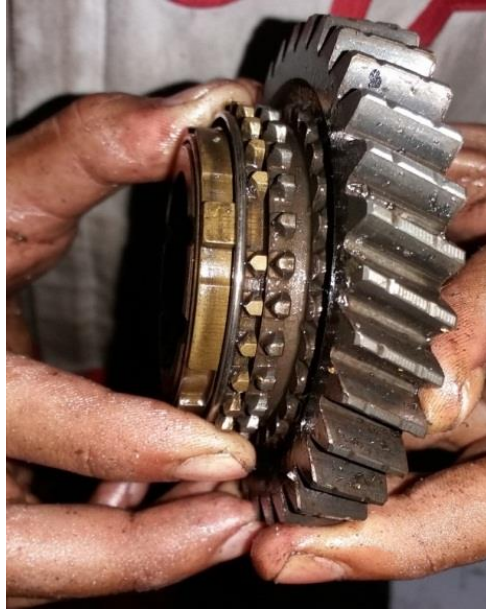
Gambar 4. 19 Pemeriksaan ring Synchronizer Gigi 1
