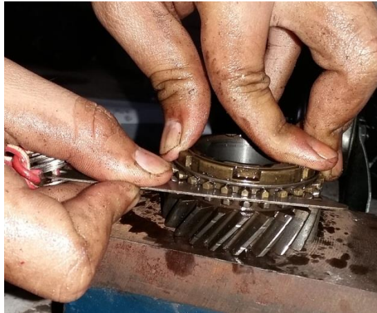
Gambar 4. 18 Pengukuran Jarak Gigi 4
