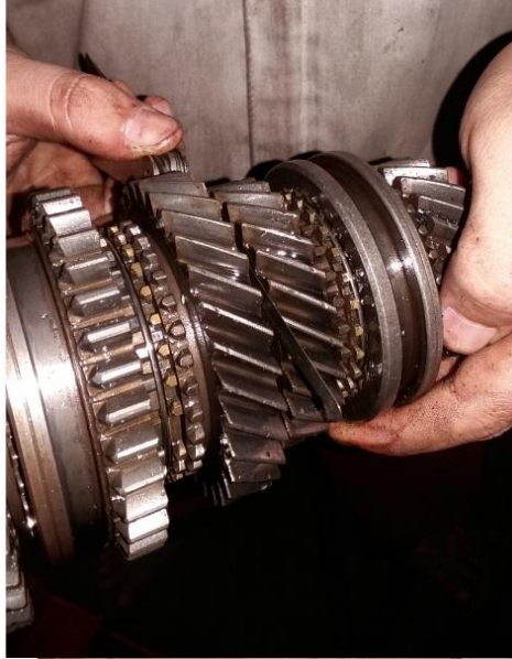
Gambar 4. 9 Pengukuran kelonggaran antara plat pemisah dan gigi ke 3
