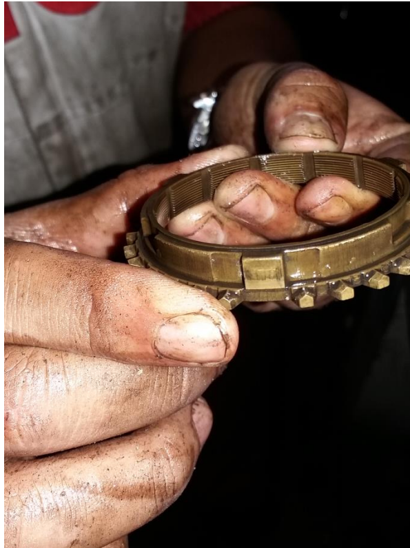
Gambar 4. 12 Periksa terhadap keausan pada ring Synchronizer .
