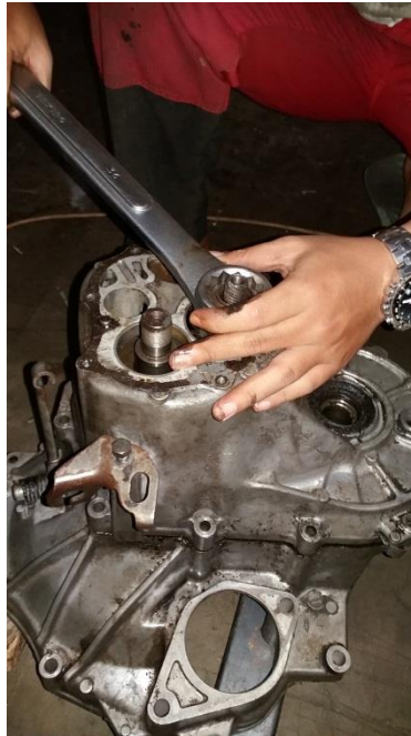
Gambar 4. 2 Pelepasan Baut Countershaft
