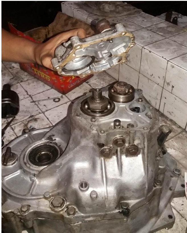
Gambar 4. 37 Memasang Tutup Tranmisi
