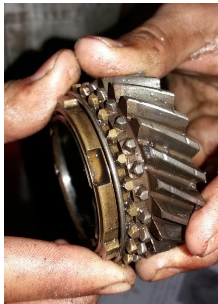
Gambar 4. 22 Pemeriksaan ring Synchronizer gigi 4
