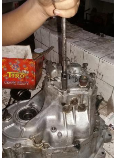
Gambar 4. 39 Memasang penutup sisi kanan
