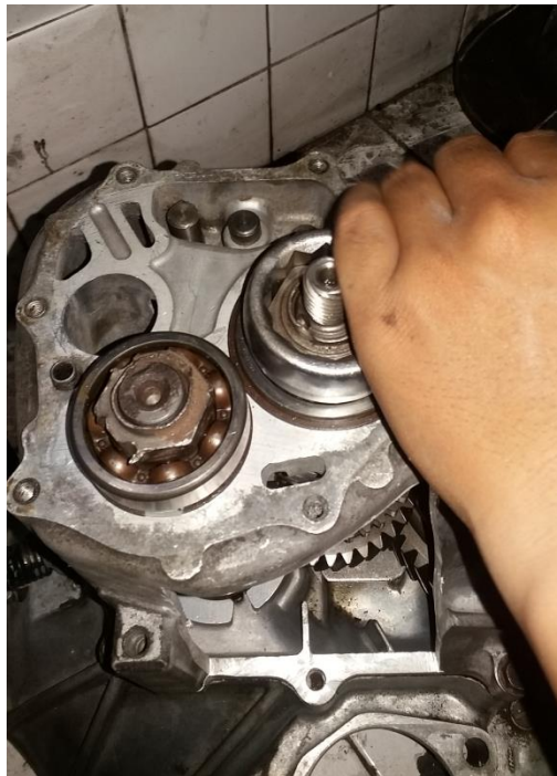
Gambar 4. 36 Memasang Mur Pengunci
