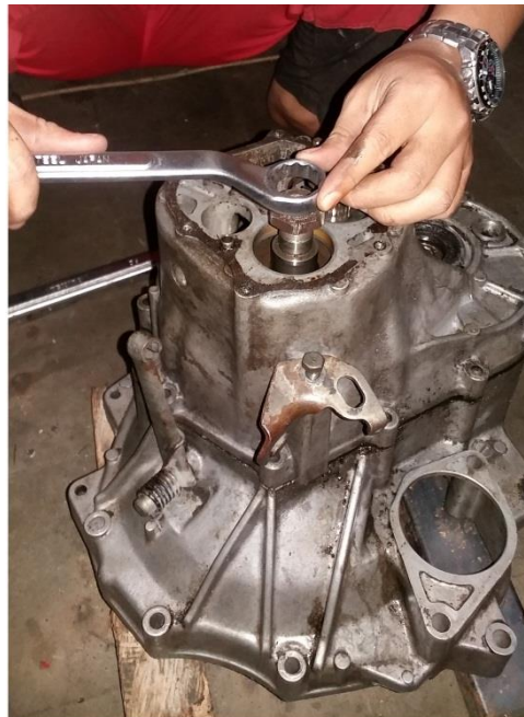
Gambar 4. 3 Melepaskan Mur Pengunci.
