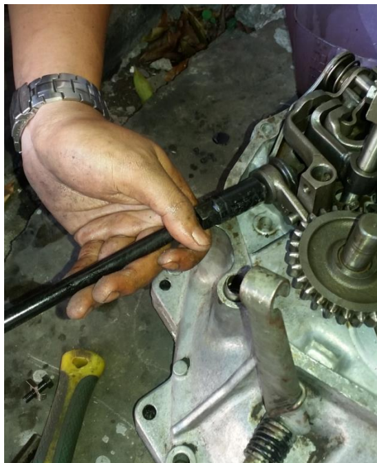
Gambar 4. 34 Pemasangan Garpu Pemindah
