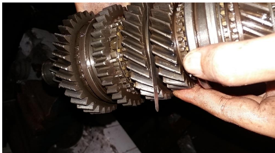
Gambar 4. 8 Pengukuran Gigi Ke 2
