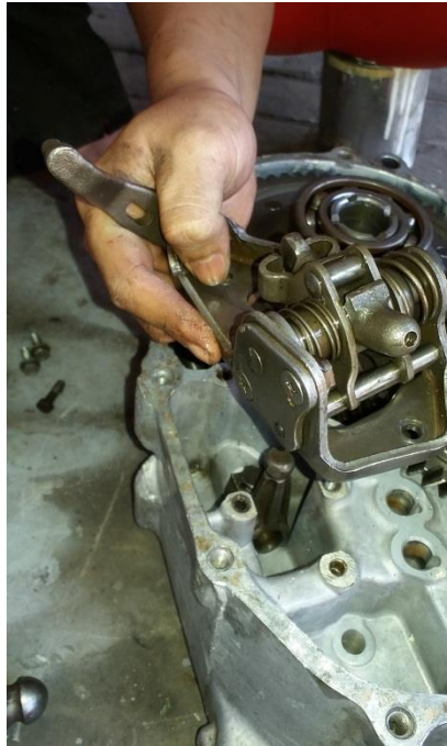
Gambar 4. 28 Memasang Penyeleksi Gigi
