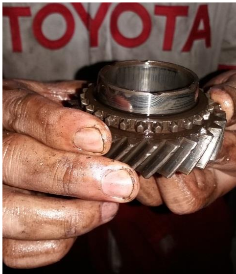
Gambar 4.13. Pemeriksaan permukaan thrust terhadap keausan.
