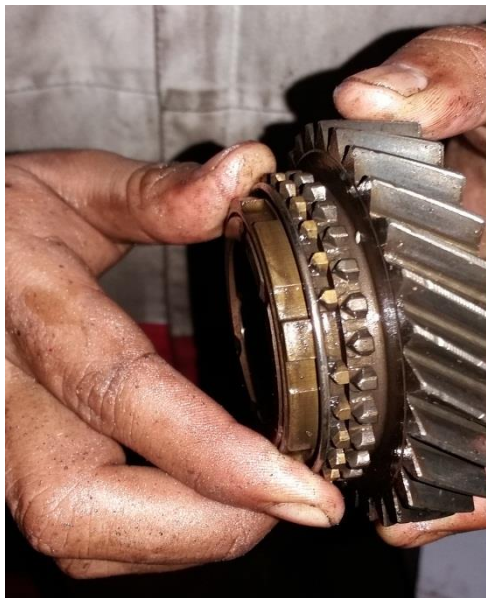
Gambar 4. 20 Pemeriksaan ring Synchronizer Gigi 2
