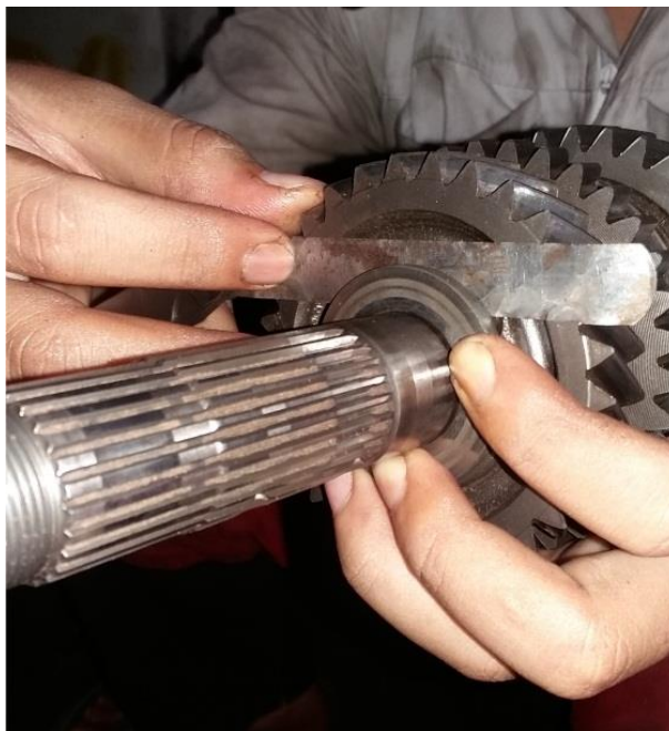
Gambar 4. 26 Pengukuran Kelonggaran antara thrust washer gigi ke 1 dan ujung tepi pada gigi ke 1
