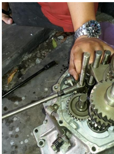
Gambar 4. 32 Pemasangan poros pemindah gigi 1 & 2
