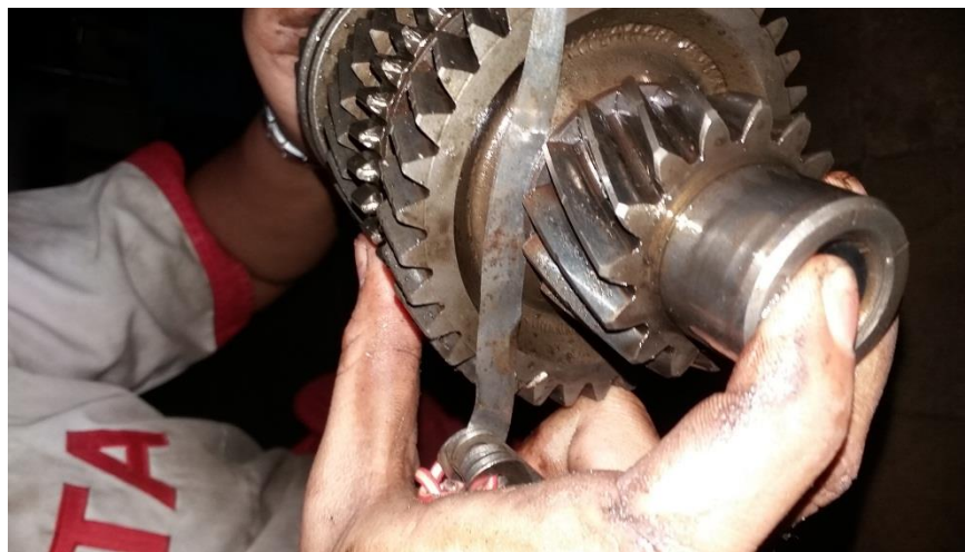
Gambar 4. 7 Pengukuran gigi pertama dengan thrust washer gigi pertama.
