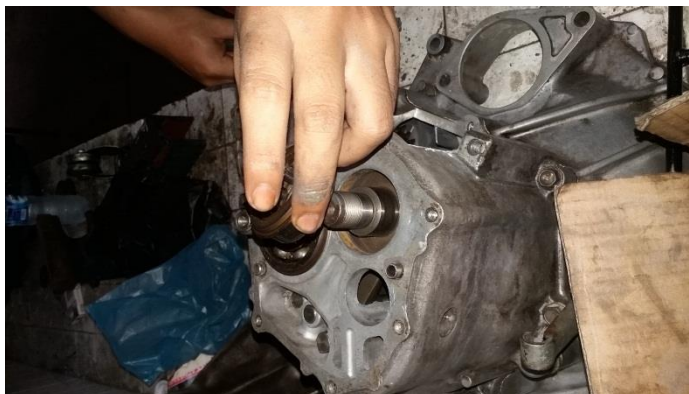
Gambar 4. 38 Memasang bantalan countervshaft dan snap ring 47 mm
