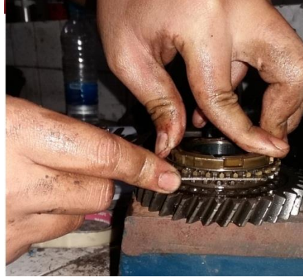
Gambar 4. 15 Pengukuran Jarak Gigi 1
