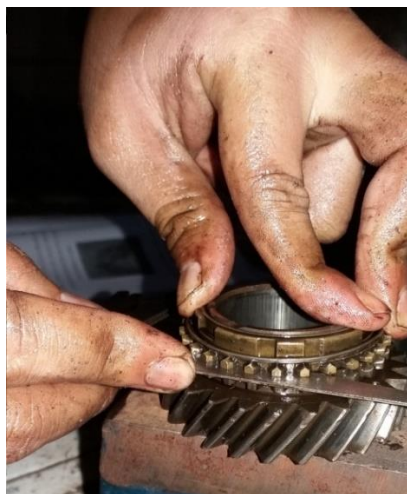
Gambar 4. 17 Pengukuran Jarak gigi 3
