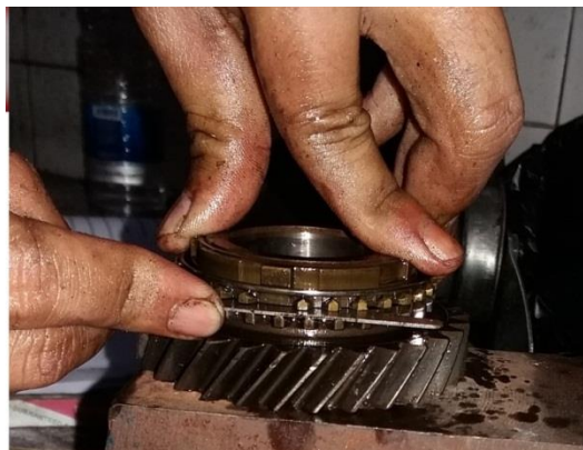
Gambar 4. 16 Pengukuran Jarak Gigi 2
